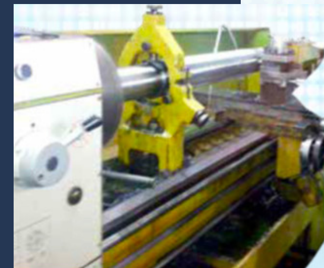
Torno de 24" de Volteo. Fabricación de Flecha.
